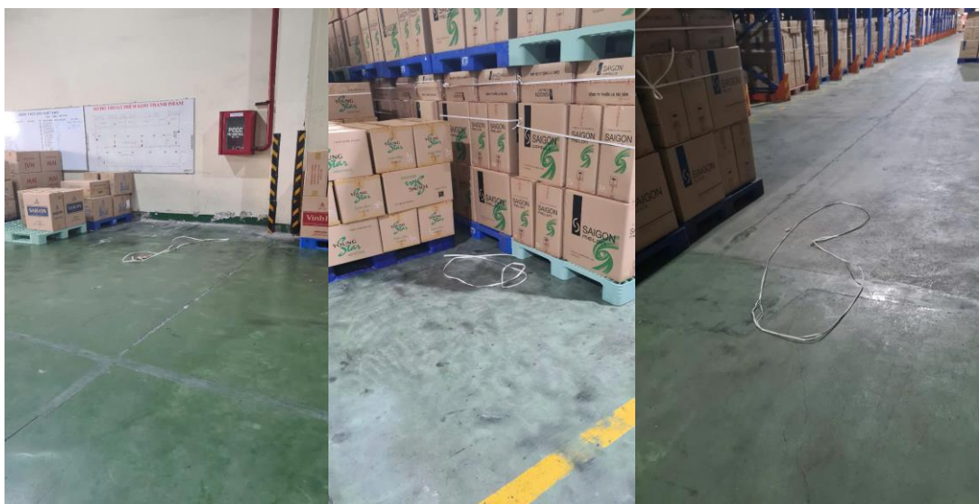
Hình 3: Dây rỗng thùng để trên sàn nhà gây nguy cơ vấp té.
